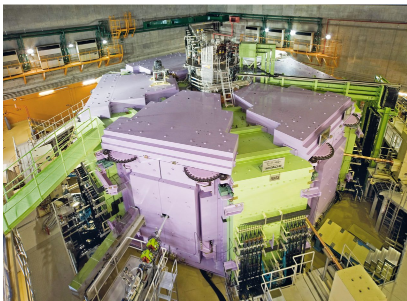
Das Superconducting Ring Cyclotron (SRC) am RIKEN Nishina Center beschleunigt Ionenstrahlen bis zu 70% der Lichtgeschwindigkeit mit den weltweit höchsten Strahlintensitäten (Bild: RIKEN Nishina Center).
